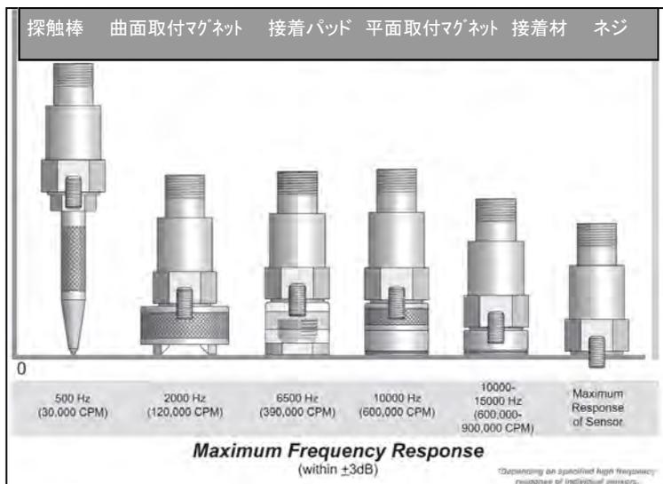
加速度センサを機械に取付ける場合、取付け方により周波数応答が変わります。加速度センサ底面と機械表面を完全に密着させる程、高い周波数応答となります。右図は、それぞれのマウント方法と周波数応答の例です。測定対象としても必要な周波数応答から、マウント方式を選定して、取付けてください。
