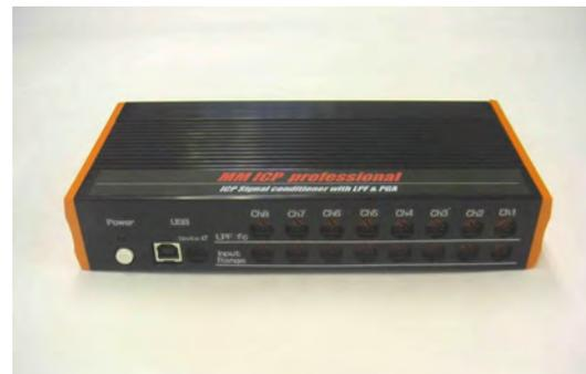
ICP加速度センサ用電源アダプタ
