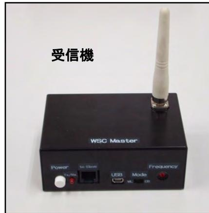
ロータリキルン炉や回転ロール・船舶推進軸等の回転する機械上での温度や電圧・ひずみ等の計測(計装)では、従来スリップリングやパンタグラフ式給電機構が使用されてきましたが、スリップリングノイズやブラシ摩耗等による寿命が問題があり、無線方式を用いて電池で長時間使えるものがほしいというニーズに合わせ、徹底した低消費電力化により電池で長時間計測が可能になりました。
