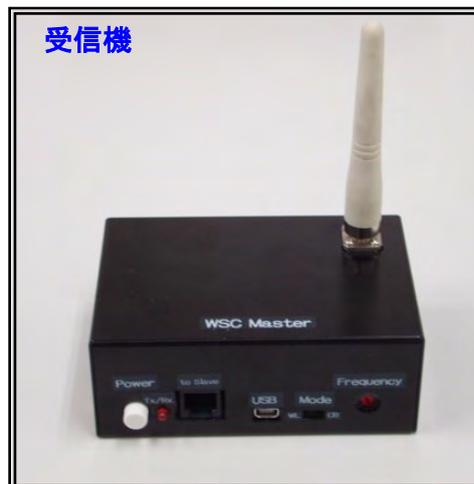
ロータリキルン炉や回転ロール・船舶推進軸等の回転する機械上での温度や電圧・ひずみ等の計測(計装)では、従来スリップリングやパンタグラフ式給電機構が使用されてしますが、スリップリングノイズやブラシ摩耗等による寿命が問題があり、無線方式を用いて電池で長時間使えるものがほしいというニーズに合わせ開発しました。徹底した低消費電力化により、電池で長時間計測が可能になりました。
